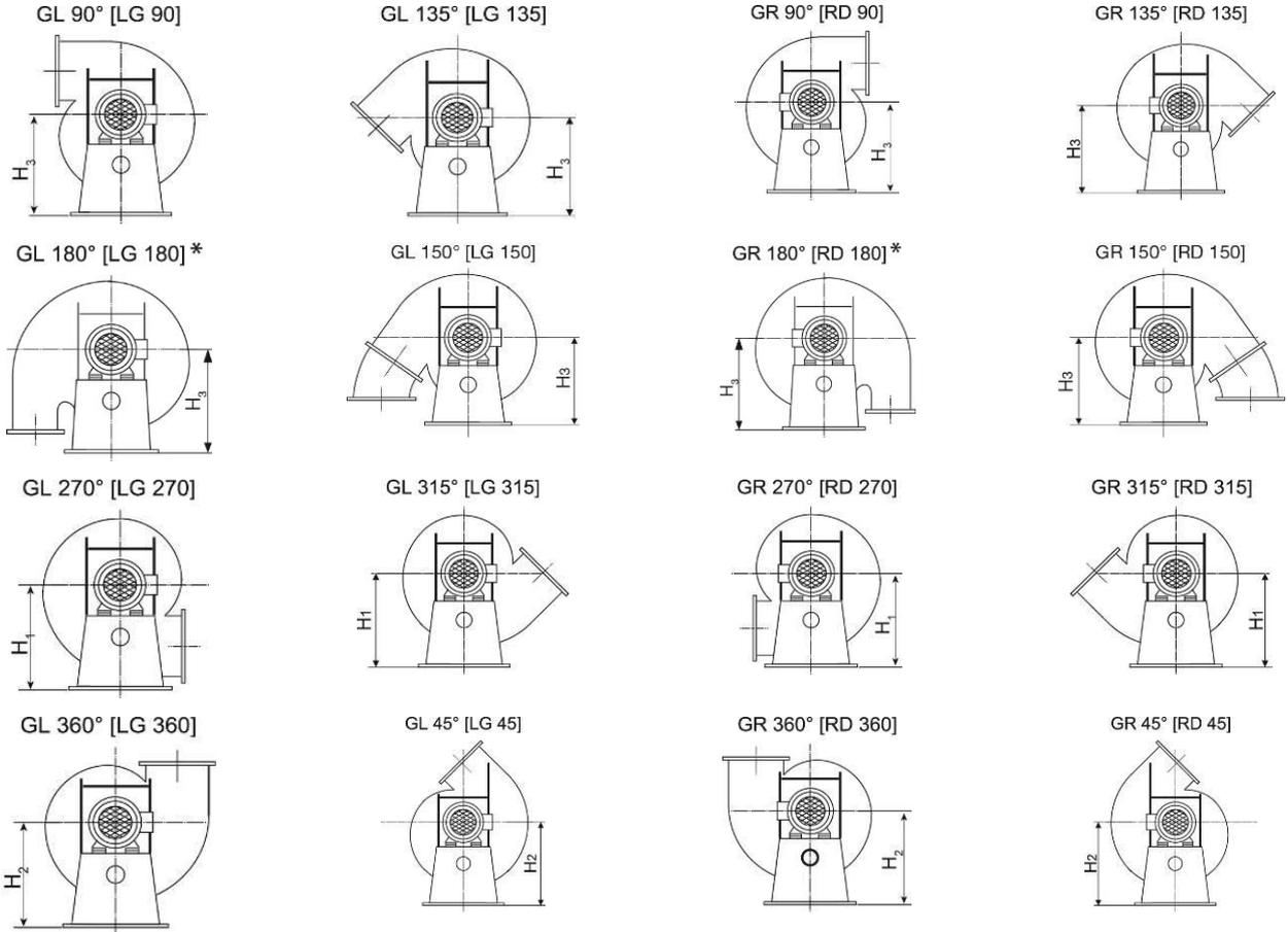
\* Gehäusestellung typenabhängig, die technische Machbarkeit wird von uns geprüft. Sollte diese nicht gegeben sein, muss die Gehäusestellung GL/GR 150° mit Rohrbogen eingesetzt werden.
